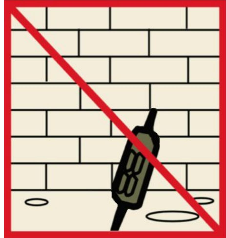
**Vermeiden Sie Funkwellenhindernisse nahe der Bridge!** Die Bridge muss guten Zugang zum GSM/Mobilfunknetz haben. Vermeiden Sie große Nähe zu Wänden, Metallgegenständen, elektrischen Geräten und bringen Sie die Bridge nicht im Untergrund oder in Hohlräumen an. In Regionen mit schwacher GSM/Mobilabdeckung **in erhöhter Position** anbringen.
