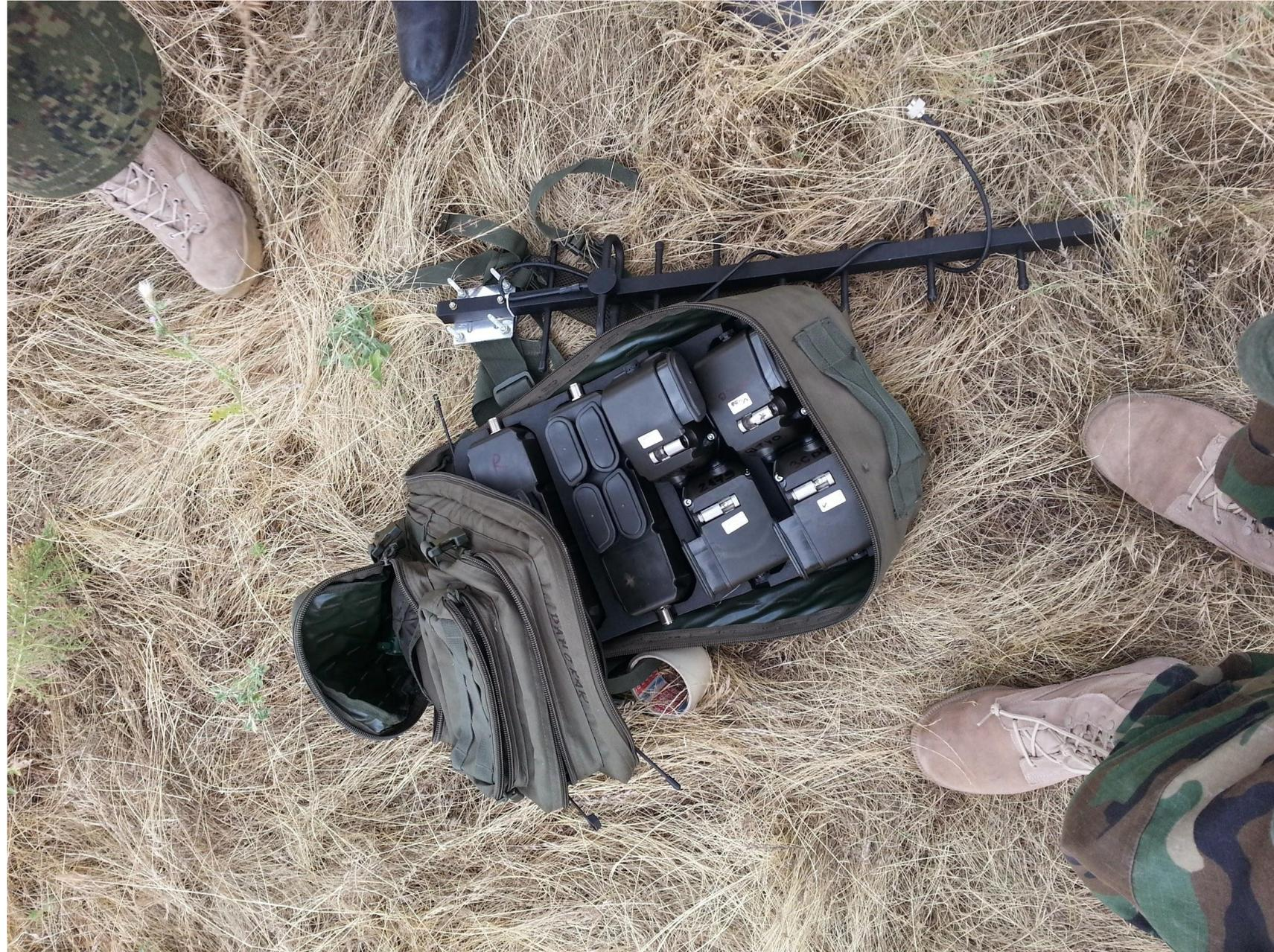
Packen Sie die Detektoren immer **verkehrtherum** ein, um eine Beschädigung von Linsen zu vermeiden.
